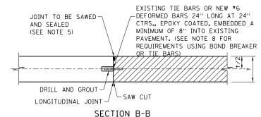
REPAIR ALONG LONGITUDINAL JOINT
