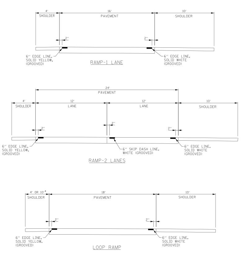
• RUMBLE STRIP SHALL BE ADDED WHEN ALONG EXIT LOOP RAMP AND LEFT SHOULDER IS 10' WIDE
