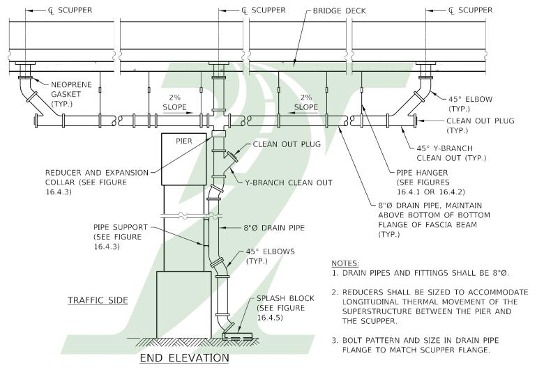
TYPICAL DRAINAGE SYSTEM DETAILS FOR SHOULDER /EXPANSION PIERS FIGURE 16.3.2
