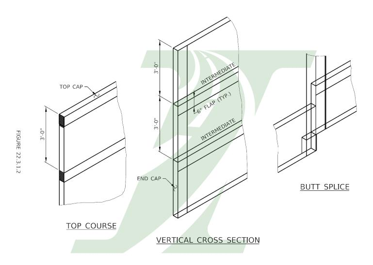
**GEOCOMPOSITE WALL DRAIN DETAILS**
