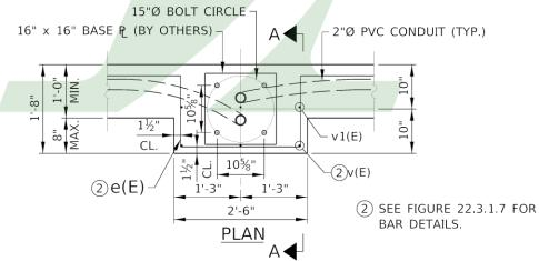
LIGHT STANDARD ON RETAINING WALL DETAILS FIGURE 22.3.1.6
