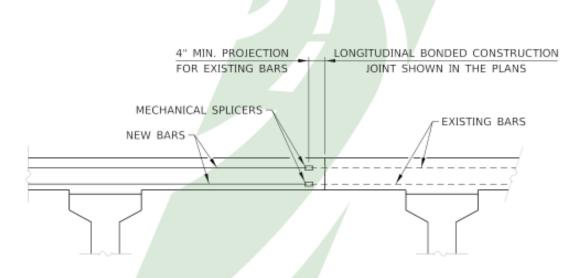
MECHANICAL SPLICE DETAIL NOTE: PPC BEAM SHOWN, STEEL BEAM SIMILAR FIGURE 15.2.1
