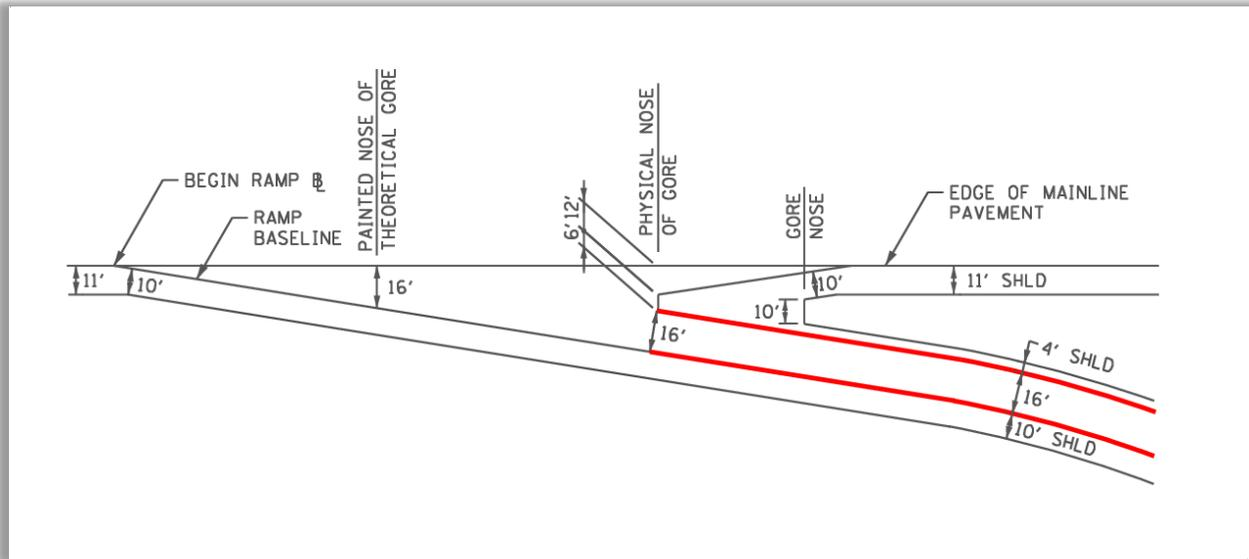
RDC FIGURE 5 TYPICAL EXIT RAMP TERMINAL
