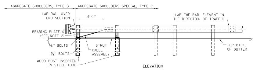
TRAFFIC BARRIER TERMINAL, TYPE T2-WITH GUTTER
